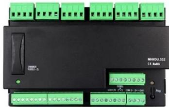
08 relés para controle de iluminação, motor, etc;
